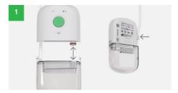
Anslut behållaren till pumpen genom att trycka på behållaren tills ett klickljud hörs på båda sidor. Fäst behållarslangen i klämman på baksidan.
