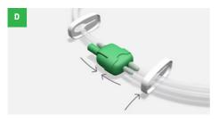
För att fortsätta behandlingen, anslut behållarslangen till förbandsslangen, lossa klämman på förbandsslangen och starta om pumpen genom att trycka ned den gröna startknappen, och släppa den efter två [2] sekunder.
