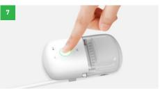
Håll sedan den gröna startknappen för pumpen intryckt och släpp den efter två [2] sekunder så att pumpen aktiveras och den gröna startknappen blinkar. Undertryck ska uppnås inom två [2] minuter efter pumpstart.
